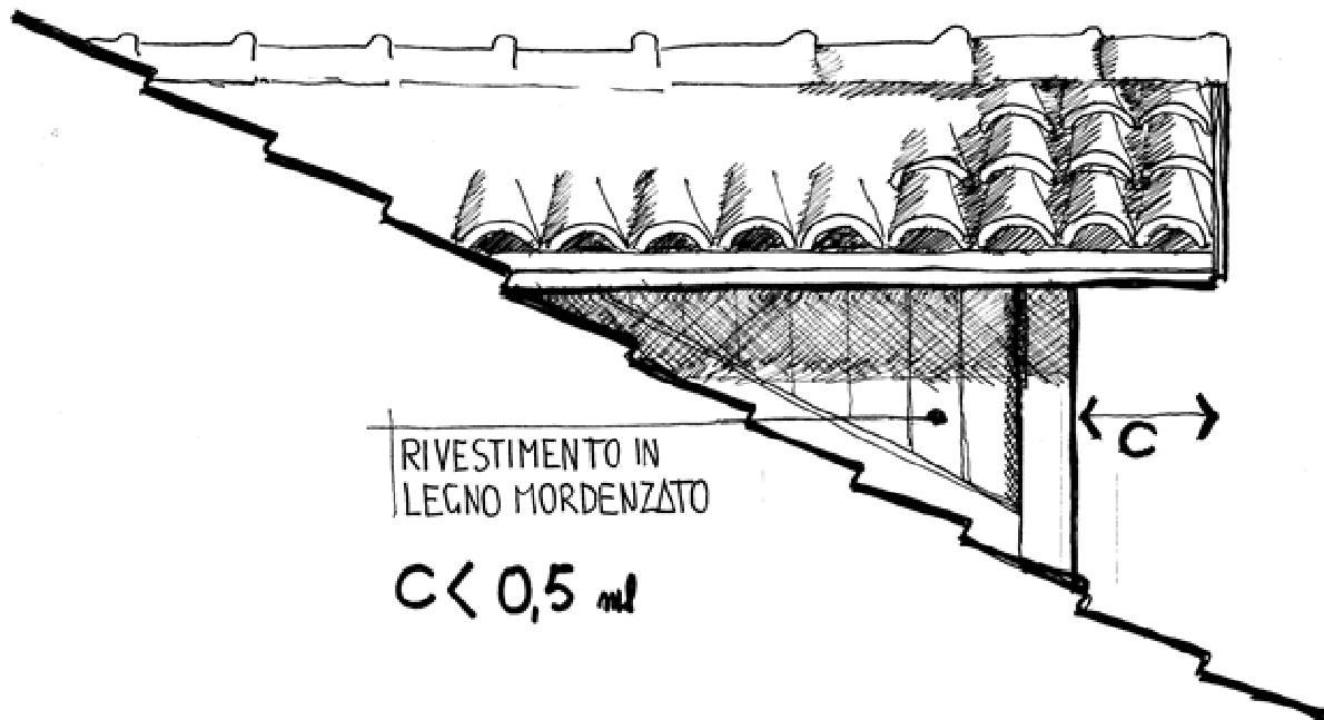
MANTO DI COPERTURA COME PER LA FALDA DI APPoggIO
